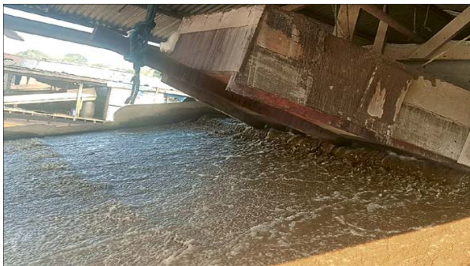
Foto 16 Canaleta con alfombra para concentración de oro aluvial en balsa en el río Beni-Beni (2019).
