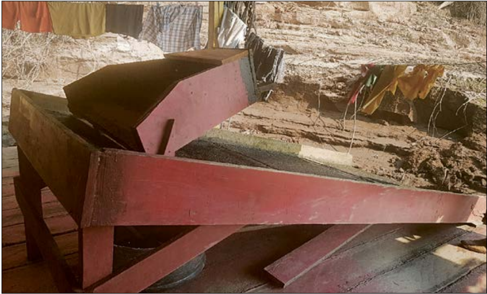
Foto 17 Canaleta secundaria posamalgamado para recuperar oro fino y mercurio, Beni (2019).
